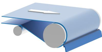
Abstreifer können an Systemen mit Trommel- und Kettenradantrieb angebracht werden. Der Abstreifer wird dafür an der 2/3-Markierung der Bandumwicklung (die sog. „Vier-Uhr-Stellung“) auf dem Trommelmotor oder dem Kettenrad ausgerichtet.
