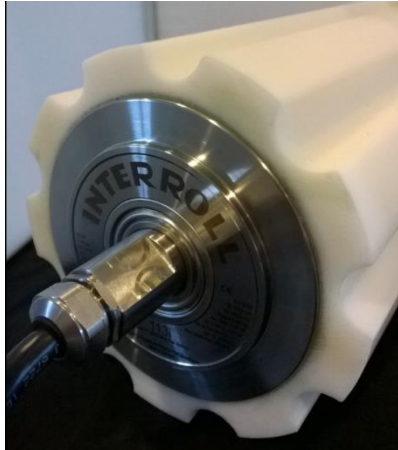
图 5 Interroll 滚筒电机 ( 配有 Soliflex 衬套 )
