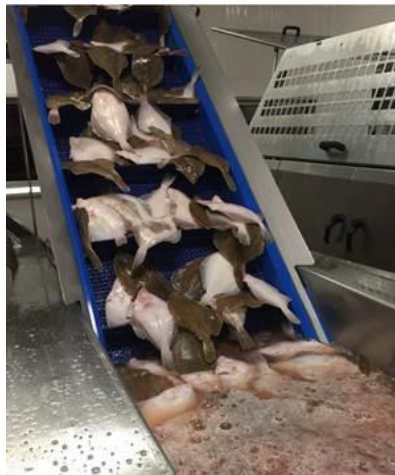
图 13 配备有挡板的倾斜式输送机
