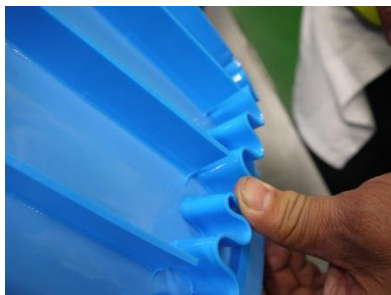
Figura 11 Taco con flujo libre de material
