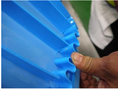
Abbildung 22 Mitnehmer mit frei fließendem Material
