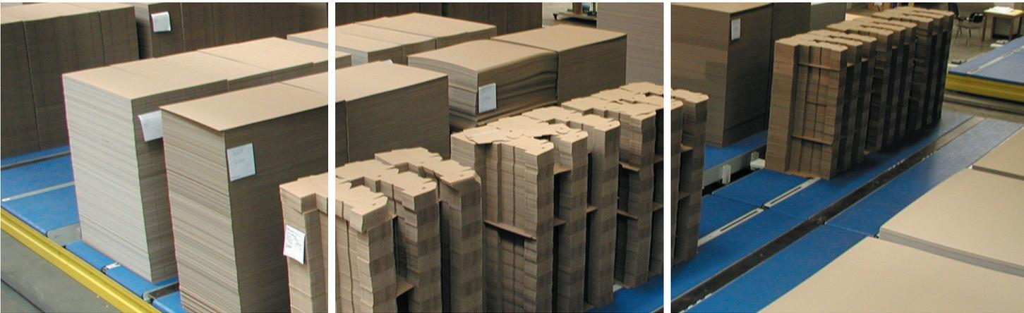
Herkömmliche Produktabnahmeverfahren mittels Gabelstapler sind für ein Wellpappenwerk keine wirtschaftliche Option mehr. Die Investition in ein integriertes, intelligentes Fördersystem mit modularen Kunststoffbändern wurde in der Wellpappenindustrie zum neuen Industrie-Standard.
