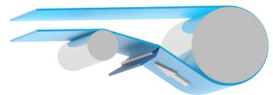
刮板位于滚筒之后。刮板可置于输送带顶面和/或输送带背面
