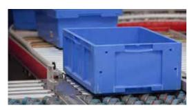
辊筒传动系统随处可见 一广泛应用于物流、仓储、制造业以及食品行业。用于实现各种各样的功能,从衔接不同的生产流程到移动成品。辊筒传动系统可降低能耗和总成本。该系统经常用于克服困难因素,如满载停止和启动、温度变化、长期接触油污、油脂和污垢,以保持各项操作顺畅进行。
