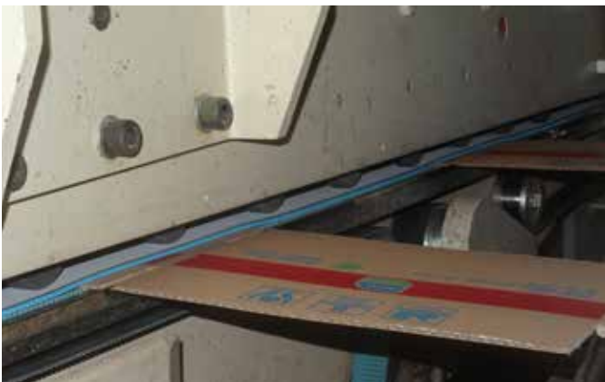
采用P6花纹的耐磨XNBR橡胶涂层，对纸箱具有出色的抓力并可提高产量。
