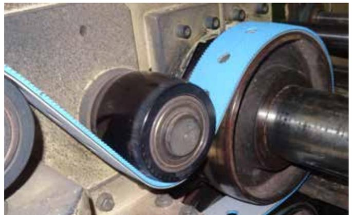
Los elementos tensores con láminas de poliamida ofrecen una gran flexibilidad y estabilidad de los bordes.
