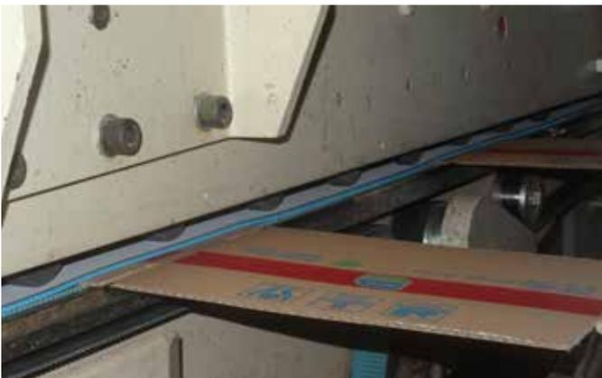
Excelente agarre del cartón y producción mejorada gracias a la resistencia a los desgastes de la cobertura de elastómero XNBR con estructura P6.
