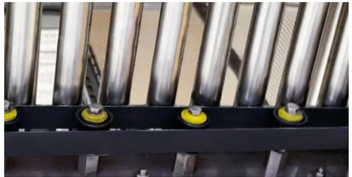
Conçues pour les charges lourdes et les longues sections de transport, notre **courroies d'entraînement de rouleaux noires pour applications sévères** est fabriquée avec une âme de traction en aramide capable de supporter les contraintes. La conception de la courroie, qui comporte des revêtements en polyuréthane extrêmement résistant à l'usure, permet l'accumulation et une faible consommation d'énergie en raison de sa grande souplesse.
