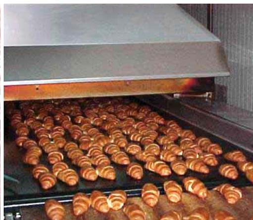
我们新型的食品级Silicone和PTFE涂层的传送带和输送带, 具有出色的耐高温和耐低温性能。
