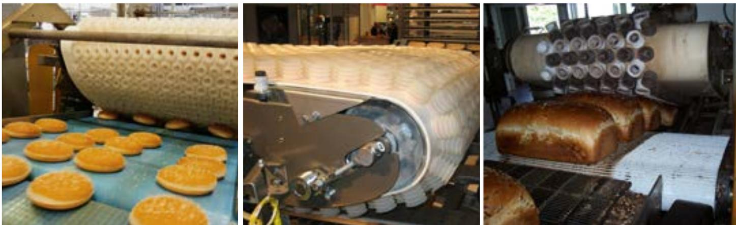
Ammeraal Beltech ha sviluppato nastri di processo specifici per l'impiego nei depanner delle linee produttive dei prodotti da forno.
