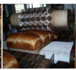
Ammeraal Beltech hat spezielle Prozessbänder für Entkapsler-Anwendungen in Bäckerei-Produktionslinien entwickelt. Diese Bände eignen sich ideal für die Entnahme von verschiedenen Bäckereierzeugnissen wie Brot, Brötchen und Pizza in der Verarbeitungslinie.
