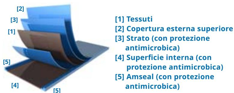
I nastri sviluppati sono composti da più strati (vedi figura) di cui l'ultimo, sulla copertura superiore, non è «trattato». Per questo strato vengono utilizzati Nonex o Ropanyl, prodotti ben noti e di alta qualità realizzati con tecniche all'avanguardia. Il risultato è un'eccellente finitura facilmente pulibile e non porosa.
