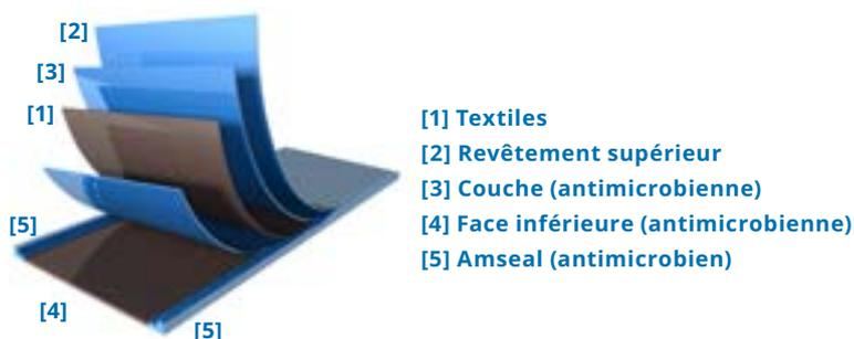
Les bandes développées sont composées de plusieurs couches (voir schéma) avec un revêtement supérieur non « traité ». Le matériau utilisé pour cette couche est du Nonex ou du Ropanyl, Ces matériaux bien connus et de grande qualité sont fabriqués avec une technologie de pointe donnant lieu à une très belle finition non poreuse et nettoyable.
