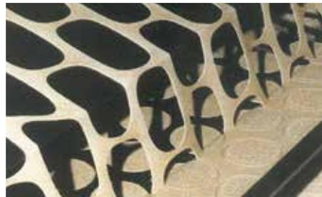
I nastri AmDough sono adatti per tutti i tipi di impasto per biscotto. I loro componenti sono sicuri e non trasferiscono alcun colore, sapore né odore ai prodotti. L'assenza di fibre antistatiche significa che i nastri possono essere utilizzati in combinazione con metal detector.
