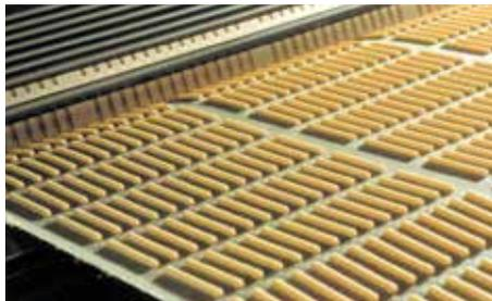
I nastri AmDough hanno importanti caratteristiche di estrazione e di rilascio. Le code dei biscotti sono limitate al minimo perché è necessaria una bassa pressione del tamburo per ottenere la formazione ottimale. Queste caratteristiche garantiscono un agevole trasferimento dei biscotti senza alcuna interruzione o deformazione dell'impasto sagomato.
