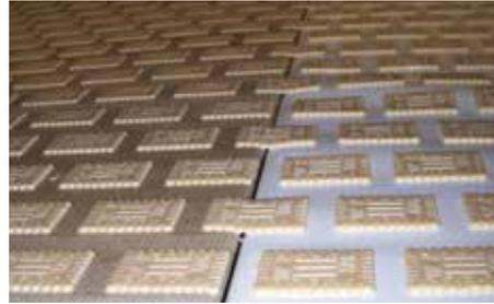
Il vantaggio principale dei nastri a manicotto AmDough è l'assenza di una giunzione o cucitura, in modo da garantire l'assorbimento continuo e il trasferimento uniforme del prodotto. Dei raschiatori possono facilmente rimuovere la pasta residua senza danneggiare il nastro.
