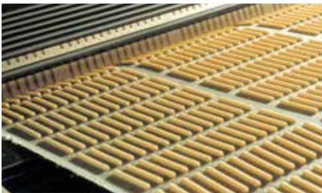
Die AmDough-Förderbänder weisen konstante Ausform- und Ablöseigenschaften auf. Am Gebäck bleiben keine Reste hängen, da der Druck, den die Ausformtrommel auf das Förderband ausübt, gering ist. Diese Merkmale sichern einen kontinuierlichen und problemlosen Teigtransport, ohne dass die Form der Teiglinge beeinträchtigt wird.
