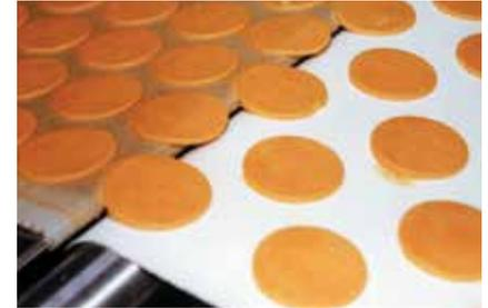
An den Austrittsseiten beider Maschinen läuft das Förderband über eine Messerkante.
