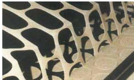
Die endlos gewebten AmDough-Bänder eignen sich für alle Arten von Feinbackwarenteige. Alle Komponenten sind sicher und übertragen keine Farbe, keinen Geschmack und keinen Geruch auf das Gebäck. Da keine antistatischen Fasern verwendet werden, können die Förderbänder auch in Metalldetektoren eingesetzt werden.
