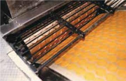
Bei Ausformtrommeln wird Teig in die Formen gedrückt, so dass Gebäckformen entstehen.
