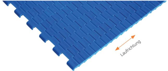
Beim Transport von kleinen und empfindlichen Produkten kommt es darauf an, eine glatte Übergabe zwischen Förderern zu erzielen, um die Qualität, den Abstand und die Ausrichtung des Produkts zu bewahren. In Anwendungen, bei denen Transferbleche vermieden werden müssen, werden traditionell gewebebasierte Bänder eingesetzt, weil sie dank ihrer Flexibilität über Messerkanten mit kleinen Radien laufen können.
