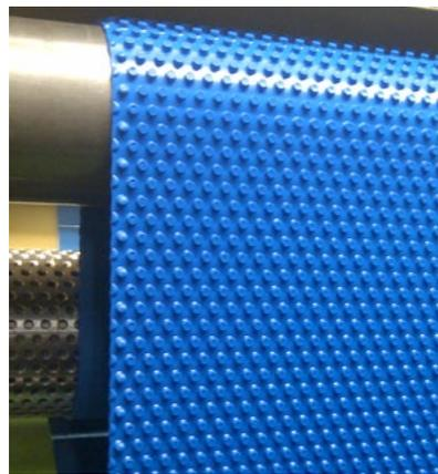
**Immagine del processo di profilatura A17 a nippli di un nastro. Personalizzabili con vari rivestimenti e profili, tali nastri sono prodotti servendosi di un sistema di controllo qualità dotato di certificazione ISO 9001:2008.**
