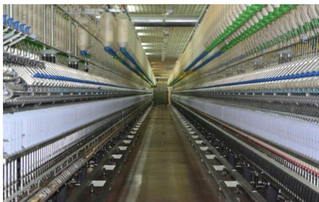
**Inoltre, la stabilità dimensionale delle cinghie QuickSplice evita la necessità di operazioni di ritensionamento, anche nei filatoi ad anello estremamente lunghi (con oltre 1000 fusi).**
