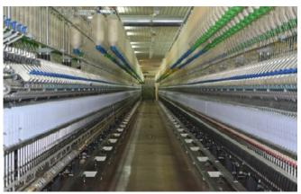
En outre, notre tissu en polyester indéformable signifie qu'un ressérage n'est jamais nécessaire, même avec de très longs appareils de filage continu (> 1.000 broches).
