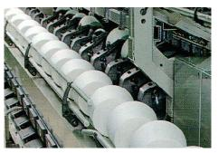
Bande transporteuse avec surface de bande lisse pour le transport de rouleaux de fil.
