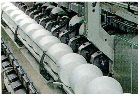
**Bande transporteuse avec surface de bande lisse pour le transport de rouleaux de fil.**
