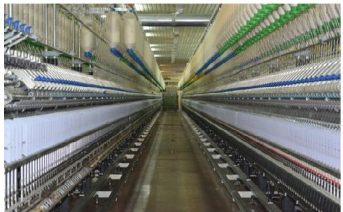
**En outre, notre tissu en polyester indéformable signifie qu'un ressérage n'est jamais nécessaire, même avec de très longs appareils de filage continu (> 1.000 broches).**
