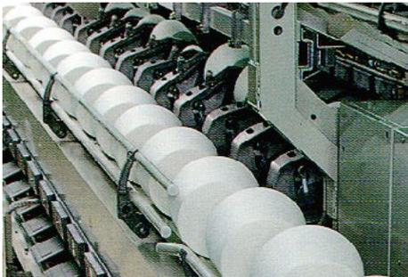
**Förderband mit glatter Oberfläche für den Transport von Garnrollen**
