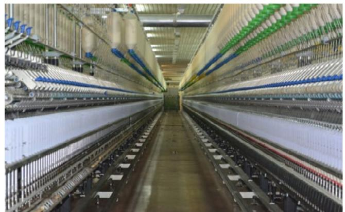
**Darüber hinaus sorgt unser abmessungsstabiles Polyestergerewebe dafür, dass selbst bei extra langen Ringspinnmaschinen (über 1.000 Spindeln) niemals nachgespannt werden muss.**
