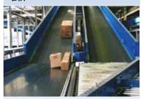
堆积阶段对于输送带寿命尤其是个 考验。针对堆积环节所产生的额外 磨损和拉扯,艾玛拉专门研发了特 殊的解决方案。
