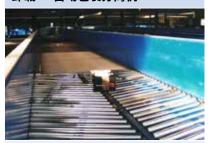
自动包裹分离机 (APS) 将简单的散件输送系统转变为高效的操作系统,可对包裹流进行下行和上行控制。不过,要实现这种效率,您的 APS需要各种输送带一起同步工作。
