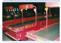
使用艾玛拉皮带的伸缩式输送带直接从车上装载和卸载包裹,不但简化了接收和传递过程,而且节省了时间和资源。我们的伸缩式输送机可伸入到车上,使用之后可折叠收缩。
