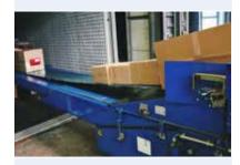
凭借出色的横向稳定性、耐化学性和室内/室外运行全面的耐候性,在各种天气条件下我们的专用输送带都可承受重负荷和油脂污染。
