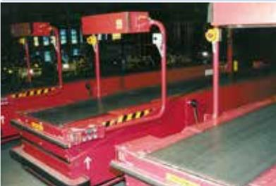
使用艾玛拉皮带的伸缩式输送带直接从车上装载和卸载包裹,不但简化了接收和传递过程,而且节省了时间和资源。我们的伸缩式输送机可伸入到车上,使用之后可折叠收缩。
