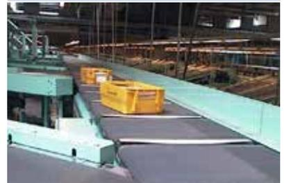
物流行业必须快速运转,否则将会面临淘汰。交叉输送带和斜盘式分拣机适用于高速物流场合,有助于最大限度地减少传递次数,同时最大限度地提高输送性能。
