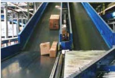
堆积阶段对于输送带寿命尤其是个考验。针对堆积环节所产生的额外磨损和拉扯，艾玛拉专门研发了特殊的解决方案。
