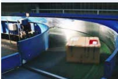
我们的转弯输送带用于高速动力转弯,可节省时间和操作空间。而且噪声低,可提供更好的工作环境。
