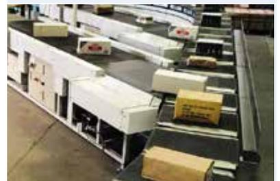
我们的输送带解决方案采用极其可靠的阻燃输送带,具有经久耐磨的表面涂层和出色的横向稳定性,随时准备迎接分拣挑战。
