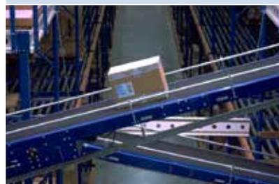
在物流中心的核心区域，直线输送机通常承担了大部分工作。它们也消耗了大部分能源。我们的皮带具有低摩擦系数的底部结构，可显著降低驱动皮带所需的动力。
