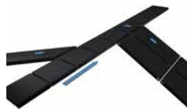
Lo smistamento dei bagagli coinvolge nastri ad alta velocità dotati di trasferimenti ortogonali o inclinati per ridurre al minimo i tempi di trasferimento.
